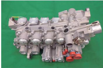
第 13 図 電子制御部と燃料制御部
