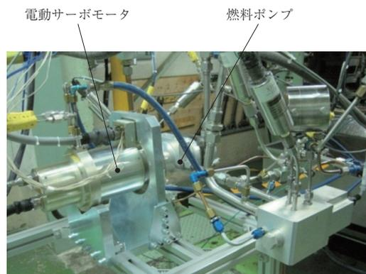
第 6 図 電動燃料システム試験
