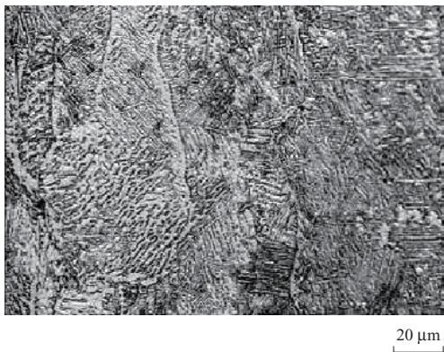
第5図 溶接金属ミクロ組織 Fig. 5 Welded metal microstructure
