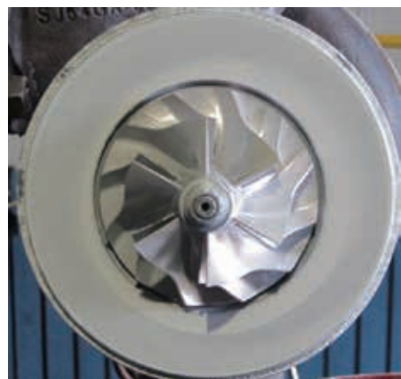
(b) スクロールとベーンレスディフューザのシュラウド壁
