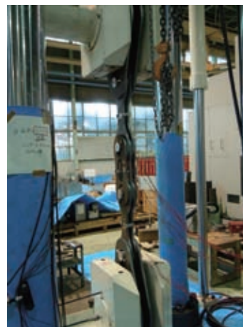
第 3 図 2 000 kN 疲労試験機によるペンダント強度試験 Fig. 3 Strength test of pendant using 2 000 kN fatigue testing machine
