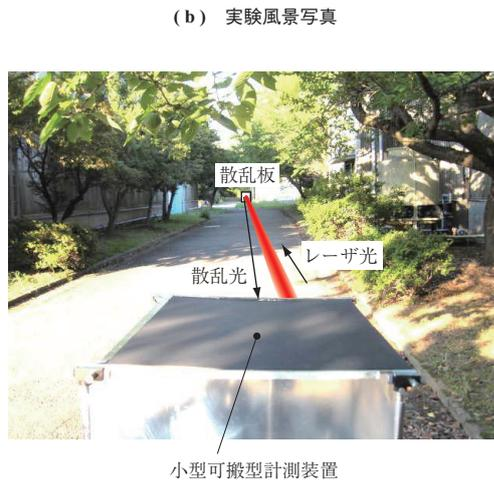
第 9 図 屋外大気中の CO<sub>2</sub> 計測試験概要
