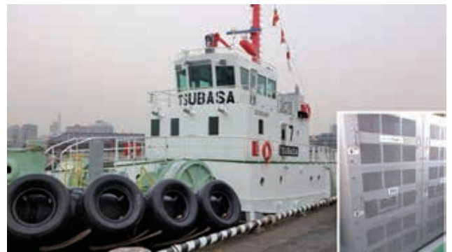
IHI 製リチウムイオン電池システムを搭載したハイブリッドタグボート「翼」
