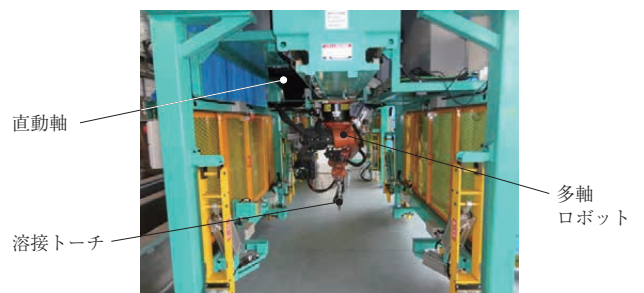
第 8 図 桁目ロボット外観 Fig. 8 Appearance of lattice assembly robot
