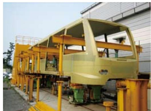
第 8 図 垂直荷重試験の様子
