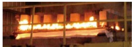
第 9 図 フロア構造の載荷耐火試験の様子
