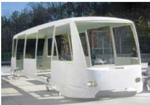
第 7 図 完成したコンポジット製車体
