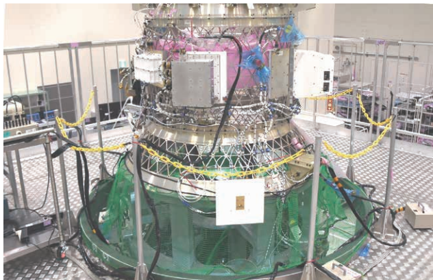
3 段機器搭載構造に機装された PSDB
