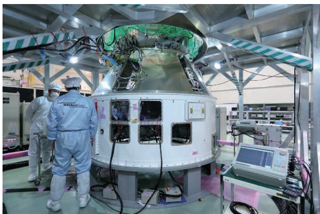
イブシロンロケット 2 号機ミッションチェックアウト (MCO) 試験の様子 ©JAXA
