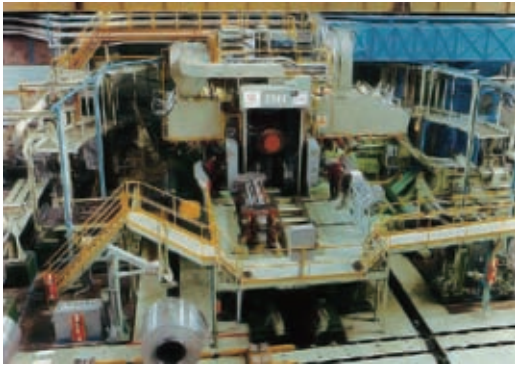
第 6 図 アルミニウム冷間シングルスタンド圧延機 Fig. 6 Aluminum single stand cold rolling mill
