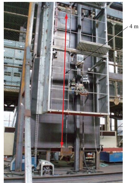
第 13 図 大形試験板を用いての溶接モックアップ試験の状況 (板厚：28 mm) Fig. 13 Appearance of welding mock up tests with using large-size test plate ( Plate thickness : 28 mm )
