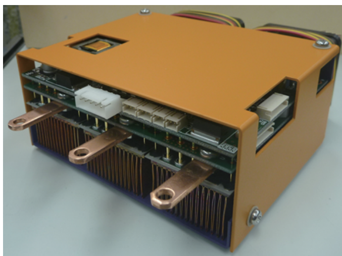
小型軽量インバーター（出力 35 kW, サイズ約 500 cc, 質量約 660 g）
