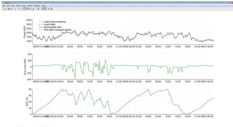
第 9 図 ES/Analyzer シミュレーション結果の例（受電電力ピークを平準化した場合のエネルギー貯蔵システムの充放電計画の一例）
