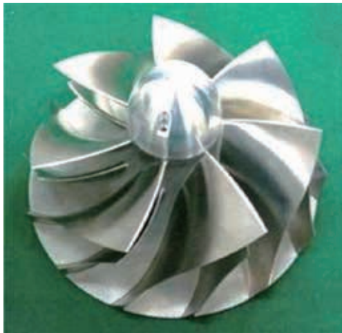
第 13 図 大容量インペラ供試体 Fig. 13 High-flow impeller used as a test piece
