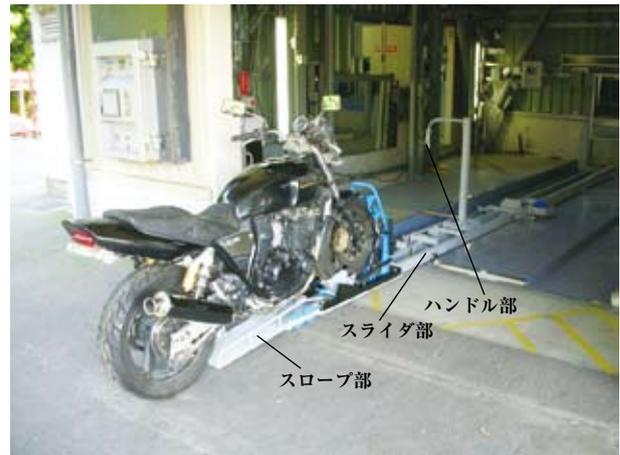
試験に耐えられることが分かり、自動二輪車駐車装置の周りに柵を設置する必要のないことも確認できた。これは、社団法人立体駐車場工業会の定める基準に、「振動数が自動二輪車の固有振動数で、加速度が 200 ～ 250 Gal の正弦波を加えた実証実験を行い、自動二輪車が転倒しないことを確認できれば、柵などを省略できる」とあることによる。
