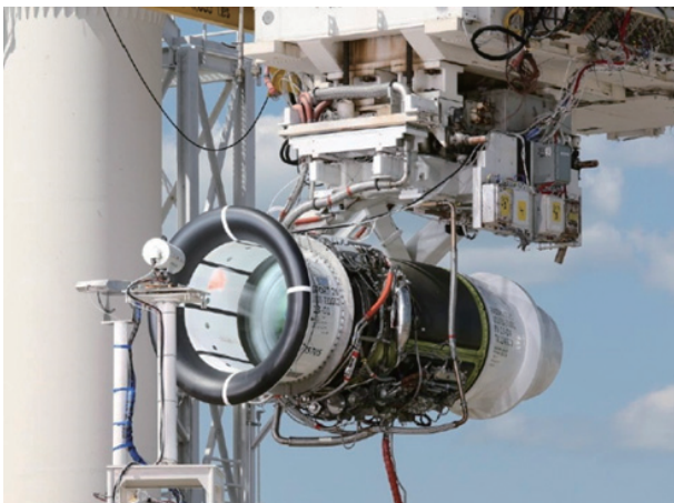
(a) 氷塊打ち込み試験
