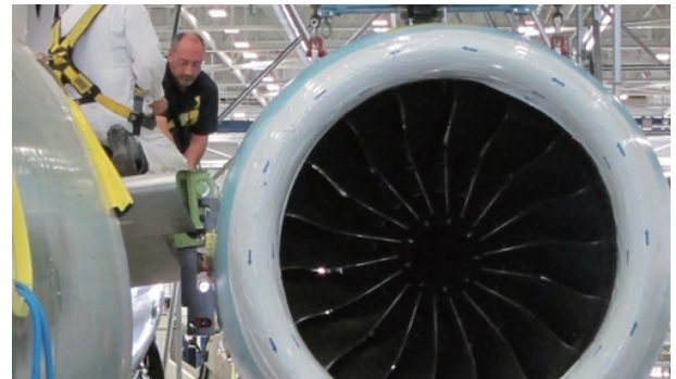
第 6 図 機体に搭載された GE Passport 20 エンジン Fig. 6 GE Passport 20 engine mounted on the Global 7000 flight-test vehicle
