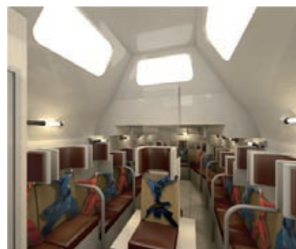
津波対応型救命艇の内部イメージ
