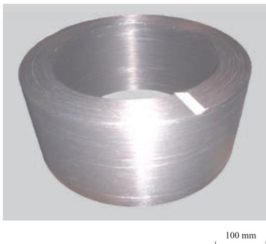
第 8 図 試作した大型 C/C モールド
