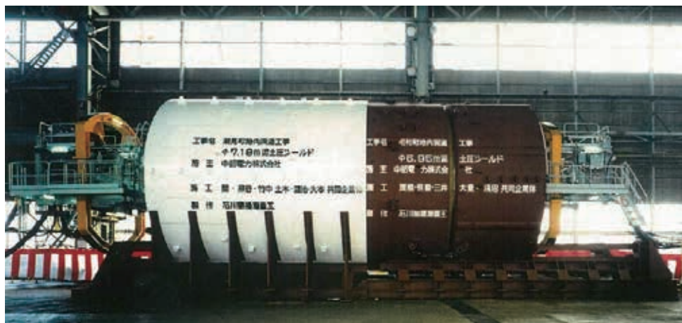
シールドマシン地中接合試験状況
