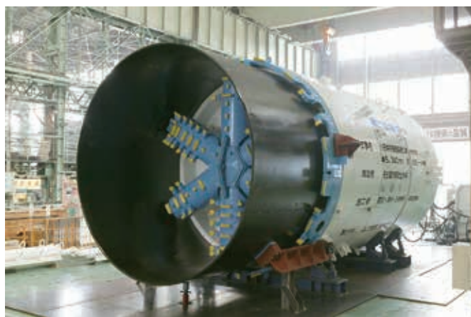
シールドマシン押出側
