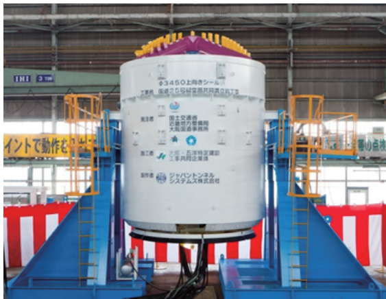
上向きシールドマシン完成検査状況
