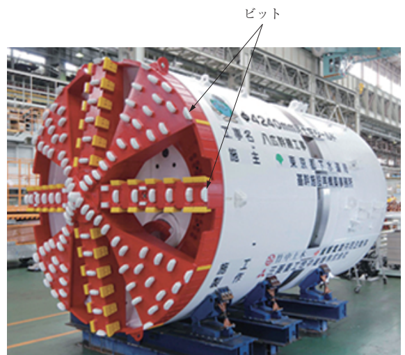
支障物切削シールドマシン完成検査状況
