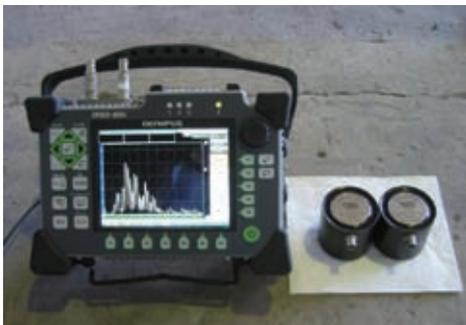
第 6 図 超音波探傷器および探触子
