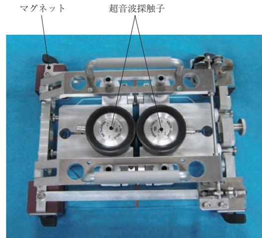
第 9 図 超音波探傷補助ジグ
