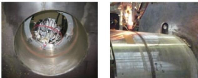
第10図 異材配管継手による確性試験状況
