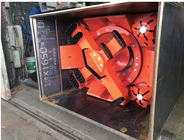
新型掘削機械（エレメント内）
