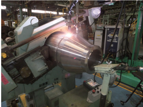
第 11 図 大径管試験体の製作状況 Fig. 11 Welding of large diameter component
