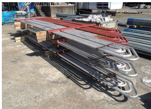
第 10 図 試験伝熱面製作状況 (9) Fig. 10 The 700℃ verification test loop welded at the IHI Aioi Works (9)
