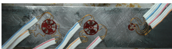
第 8 図 試験体に接着した各種ひずみゲージの写真 (ケース 1) Fig. 8 Various strain gages on the specimen (Case 1)
