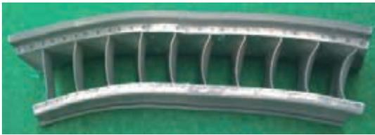
第 12 図 高圧圧縮機静翼試作結果（従来バインダ）
