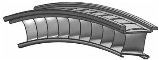
第 6 図 ジェットエンジンの高圧圧縮機静翼の外観
