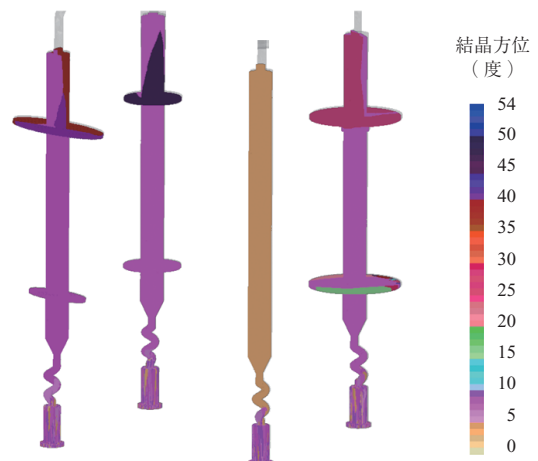
第5図 単結晶鋳造における等軸晶の発生予測例 Fig. 5 Prediction example of equiaxed grain in single crystal casting
