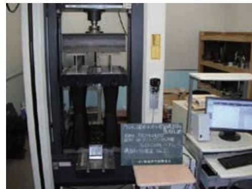
第14図 鉛直方向圧縮強度試験状況（単位：mm） Fig. 14 Vertical compression test (unit:mm)
