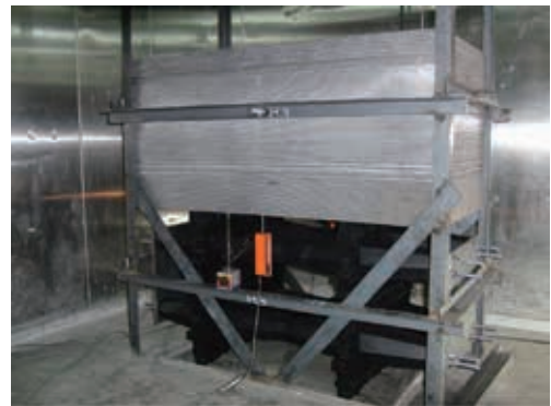
第 19 図 水平方向圧縮クリープ試験状況
