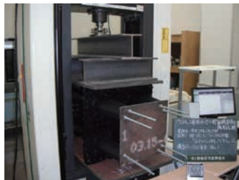
第16図 水平方向圧縮強度試験状況(単位:mm) Fig. 16 Horizontal compression test (unit:mm)
