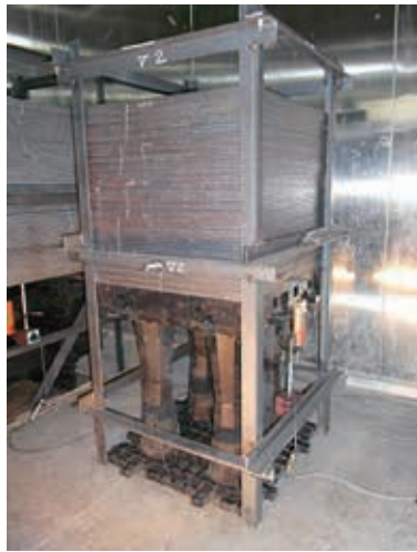
第 17 図 鉛直方向圧縮クリープ試験状況
