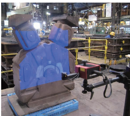
第 5 図 V28AHX 機関の鋳造木型の三次元寸法計測状況と計測結果
