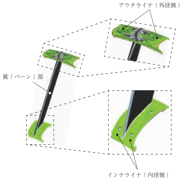
(b) 内径側の翼 (ペーン) 支持部の拡大図 (インナライナを削除して図示)
