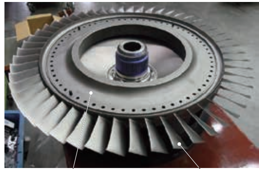
第 9 図 低圧圧縮機第 2 段 IBR Fig. 9 Low pressure compressor stage-2 IBR
