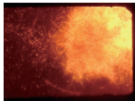
第15図 木粉専焼火炎 Fig. 15 Photos of flames from wood powder firing
