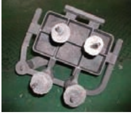
第 12 図 箱型模擬材の試作品外観と蛍光浸透探傷検査結果 Fig. 12 Photos of casting sample and of PT image
