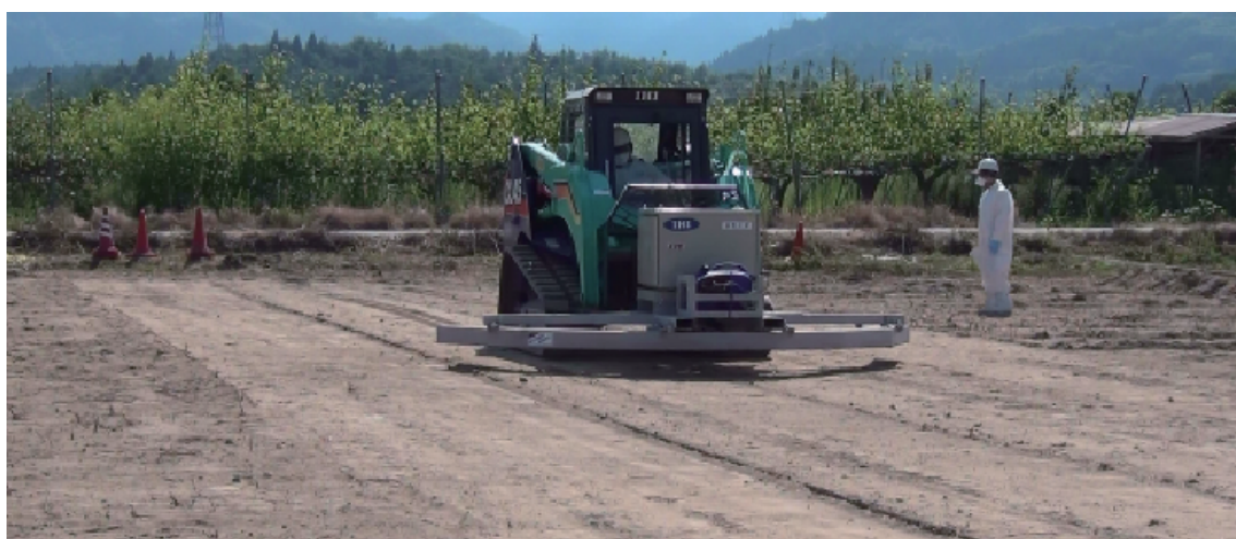
福島県双葉郡大熊町の農地における表土剥ぎ取り試験および放射線二次元分布測定試験の様子
