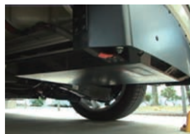
非接触給電システムを搭載した電気自動車試験車
