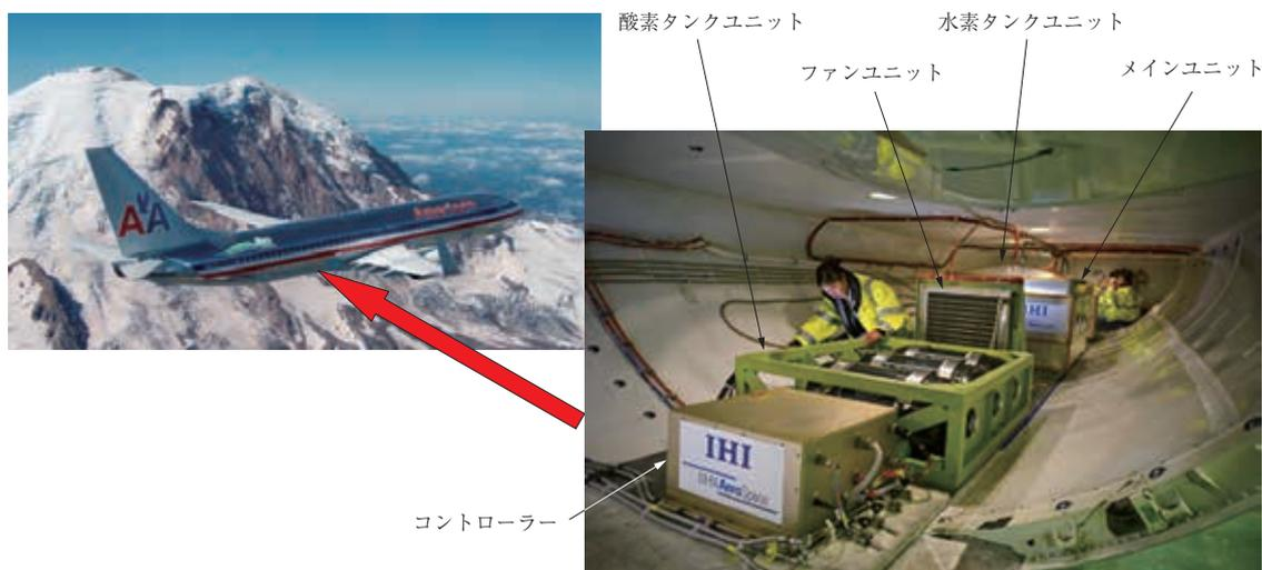
B737-800 機体の貨物室内に搭載された再生型燃料電池 ( 提 供 : ボーイング社 )
