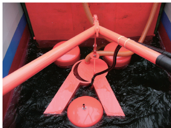
第8図 改良フロート搭載型浮遊堰式油回収装置
