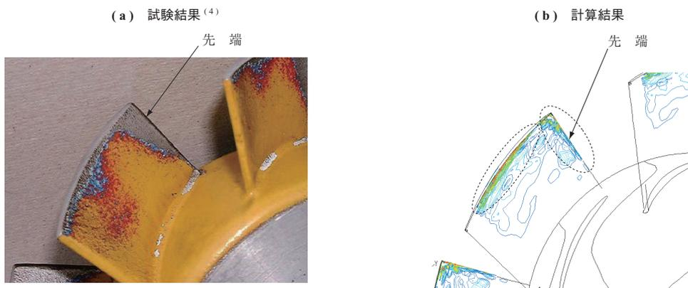
第 13 図 動翼正圧面でのエロージョンの様子
