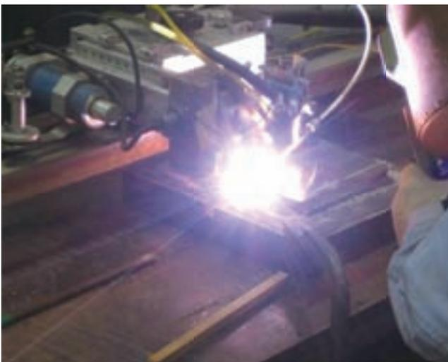
第 7 図 Ni 基合金試作板の溶接状況
