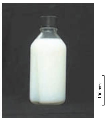
第1図 シクロペンタン分散液蓄熱材 Fig. 1 Cyclopentane-in-water emulsion
