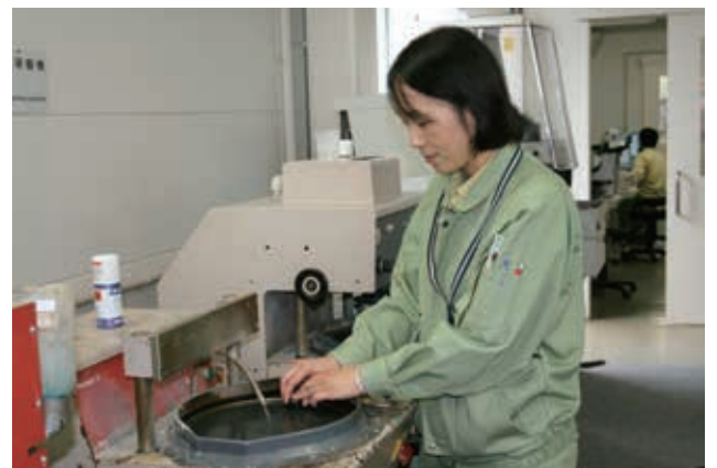
研磨作業 自動研磨機による研磨が主流だが手研磨も行う
