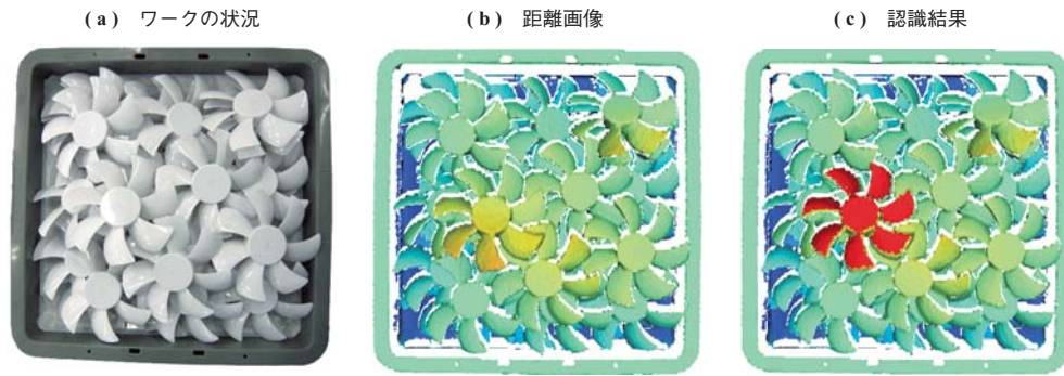
第 5 図 CPU ファンに対する三次元位置・姿勢の認識結果例 Fig. 5 Results of 3-D recognition for fans
