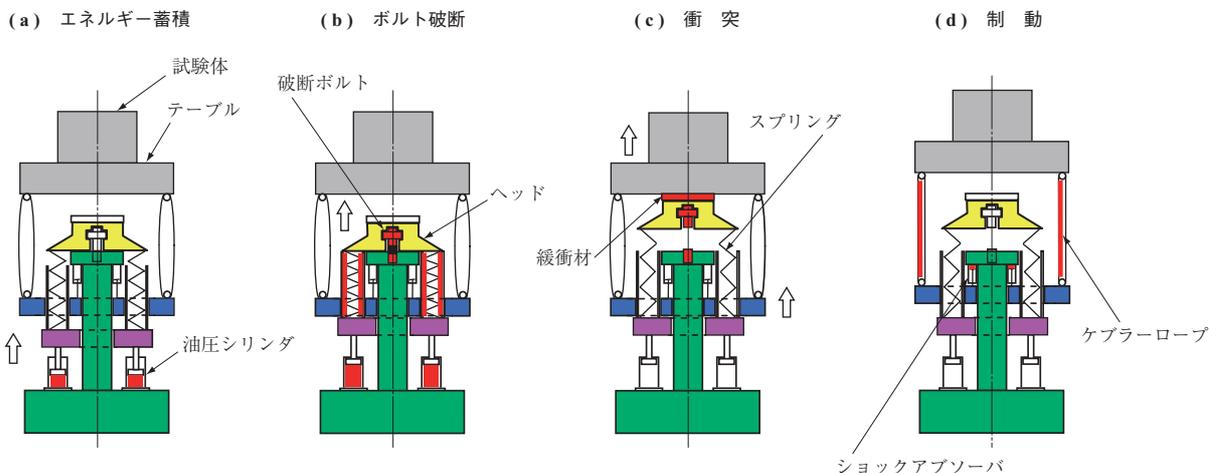
第 3 図 衝撃試験装置動作図
