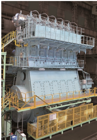
第 1 図 国内最大級のテストエンジン (6X72DF) Fig. 1 2 stroke test engine in IPS (6X72DF)
