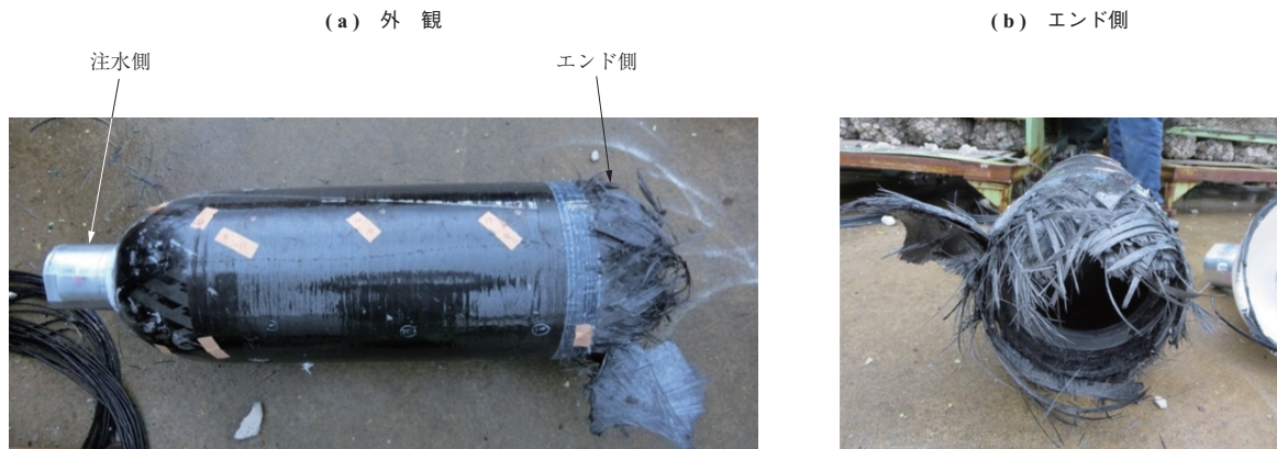
第 5 図 破断時の CFRP 製圧力容器 Fig. 5 Picture of CFRP pressure vessel after broken
