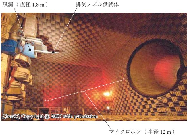
第 9 図 QinetiQ の無響風洞騒音試験場
