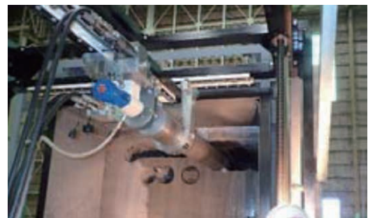
第 7 図 インフレートシールの要素試験の状況 Fig. 7 Condition of component test for inflation seal
