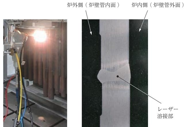
ボイラ炉壁管パネルのモックアップでのレーザー溶接試験およびレーザー溶接部の断面写真
