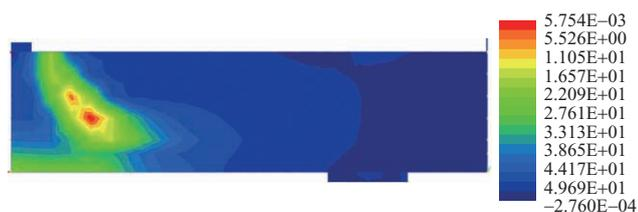
第 16 図 最大荷重時の第一主ひずみコンタ（押抜きせん断試験）
