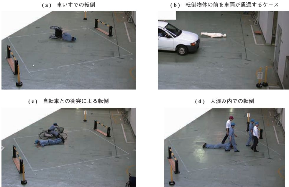
第 12 図 さまざまなケースでの転倒検知試験 Fig. 12 Falling down object detection test in various cases
