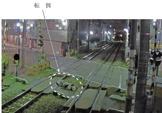
第 13 図 実際の踏切での転倒検知試験状況 Fig. 13 State of falling down object detection test in actual level crossing
