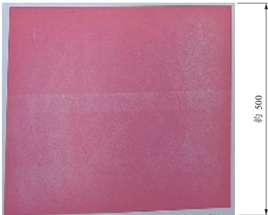
第 10 図 圧力測定紙による面圧分布測定 (単位 : mm)
